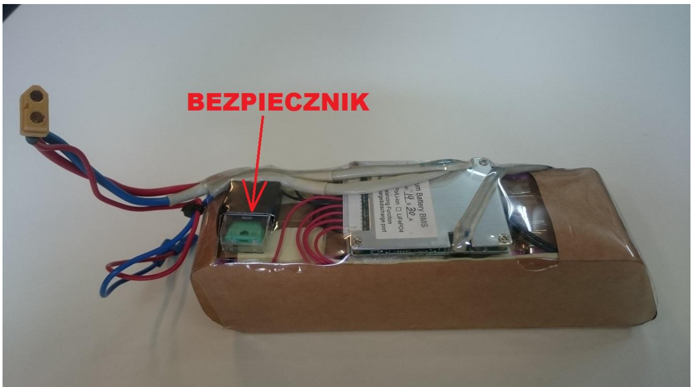
Rys. 11 Miejsce umieszczenia bezpiecznika w akumulatorze
